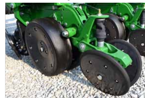
➤ Figura 11. Sistema controlador de presión en barre rastrojos, de la marca John Deere que forma parte de su cuerpo de Siembra Exact Emerge
