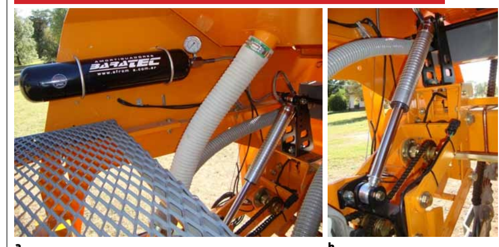
Figura 1. a) Amortiguador Baratec b) Acumulador Hidroneumático.
