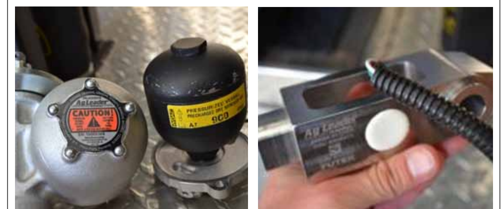
Figura 7. Izquierda: sistema actuador y amortiguador mixto (hidráulico + nitrógeno) desarmado, donde se puede observar el tanque de almacenamiento de Nitrógeno. Derecha: sistema de medición de presión que se instala en el tope de la rueda limitadora. Planting.
